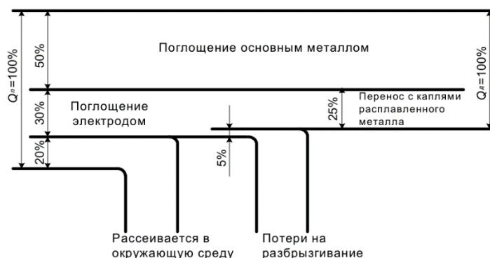
Рис. 5.2 Схема теплового баланса электрической сварки плавящимся электродом
